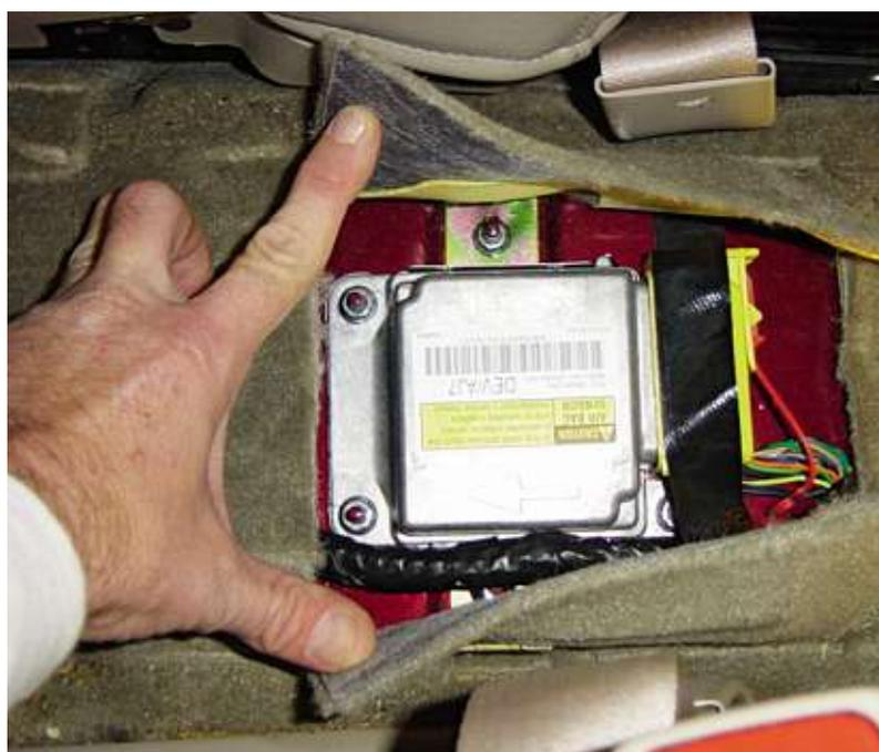
Airbagsteuergerät eines Pkw Toyota unter der Mittelkonsole.
